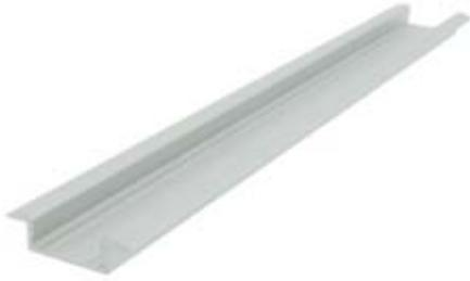
Profile aus eloxiertem Aluminium für optimale Montage von flexiblen LED-Bändern im Ladenbau, bestmögliche Wärmeableitung durch den Aluminium-Körper für lange Lebensdauer der LEDs, mechanischer Schutz und optimale Lichtverteilung durch flache oder halbrunde, klare oder opale PMMA-Abdeckung (optional). Montage durch Schrauben, Kleben oder Einfräsen in Platten durch geringe Bauhöhe leicht möglich
