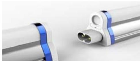
Anreihbare LED-Module mit integriertem Treiber. Ersatz für konventionelle T5-Leuchtstoffröhren in Linienlichtern, in Regalen und Kühltruhen in Einkaufszentren, Geschäftslokalen. Reichhaltiges Zubehör für einfache Montage und flexible Lösungen. Formschlüssige Verbindung. Aluminiumgehäuse mit Polykarbonat-Abdeckung. Einfache Montage mit den mitgelieferten Klemmen und genormtem Stecker. Verbindungselemente mit Schalter optional.
